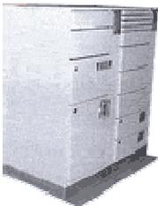
In grandi aziende, nelle banche e ovunque ci sia bisogno di gestire una complessa e delicata rete di computer e apparecchiature, sono usati grandi computer, detti **Server**, per la gestione centralizzata della rete interna e di tutte le risorse ad essa collegate. In generale i Server sono computer specializzati nella gestione del traffico di dati sulle reti di computer ottimizzando le prestazioni della rete in termini di velocità di accesso e di rapido scambio di dati.
